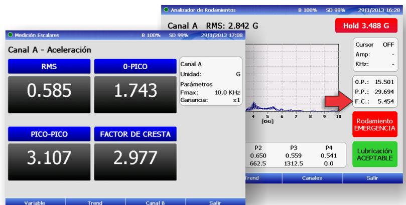
En una onda sinusoidal perfecta, con una amplitud de "1", el valor RMS es igual a .707, y el factor cresta es entonces igual a 1.41. Una onda sinusoidal perfecta no contiene impactos y por lo tanto el factor cresta con un valor superior a 1.41 implica que hay algún grado de impacto en la señal.
