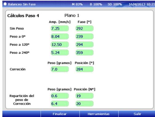
Al completar este último paso, La pantalla mostrará la corrección a realizar, con la opción de la repartición del peso de corrección, para finalizar, con la tecla de función F2.
