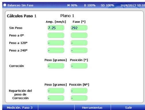
Los valores de la medición sin peso, serán ingresados por el sistema en la pantalla de cálculo.
