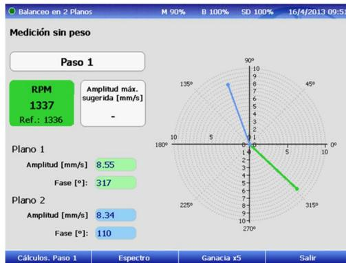
Medición sin peso: Corresponde a la medición de amplitud y fase de la componente de vibración de 1xRPM de la máquina en las condiciones originales de desbalanceo.
