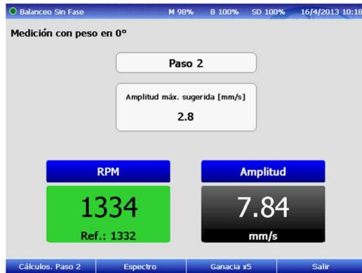
La medición espectral de este paso, puede verse con la tecla de función F2.
