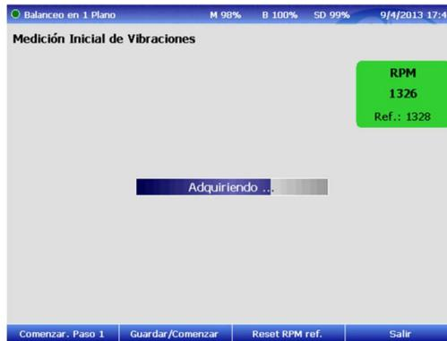
Como el valor de tolerancia de la variación de RPM, por defecto es de 5% de la referencia medida en primera instancia, cualquier variación mayor a este valor, será reflejado con color amarillo o rojo, según los niveles de desviación.
