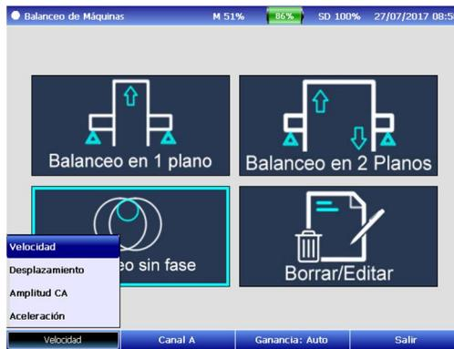
Las variables de Velocidad, Desplazamiento y Aceleración, son provenientes de la señal de las entradas Channel A y Channel B, en canales 1 y 2 de acelerómetros.
