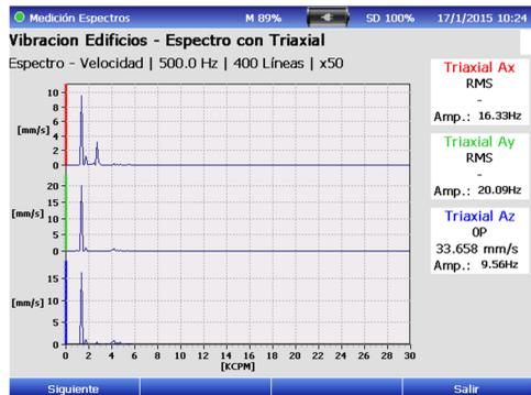
La pantalla mostrará la configuración de la medición y un mensaje central que indica que está en proceso de medición, al finalizar el tiempo estipulado se podrá ver en pantalla los tres espectros en escala lineal representativos de cada eje, sobre la derecha se podrá observar el valor de la velocidad 0-Pico total para los tres ejes medidos junto con la mayor amplitud medida y su frecuencia.
