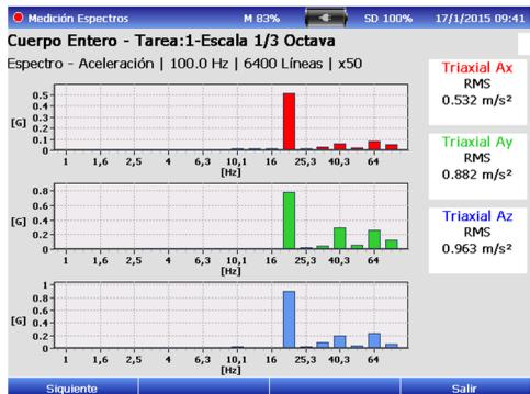
Volviendo a presionar F1 se efectuará la ponderación en frecuencia de las mediciones, mostrando sobre la derecha el valor ponderado de la aceleración para cada eje.
