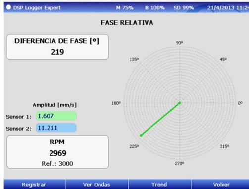
La diferencia de fase relativa se muestra en un recuadro arriba en la pantalla de medición, este campo será el indicado para realizar los diagnósticos de máquinas.
