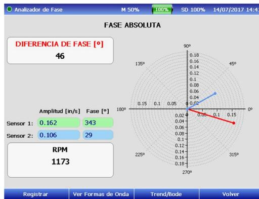
La RPM que se adquieren con el sensor óptico se muestra en tiempo real sobre un recuadro.
