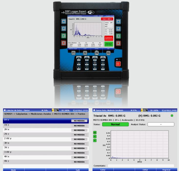
Durante la ruta de medición en modo automático las mediciones de las distintas direcciones del punto, se miden simultáneamente y se muestran los indicadores de estado de ellas en la primera medición visualizada, pudiendo alternativamente ver los espectros de las otras direcciones.
